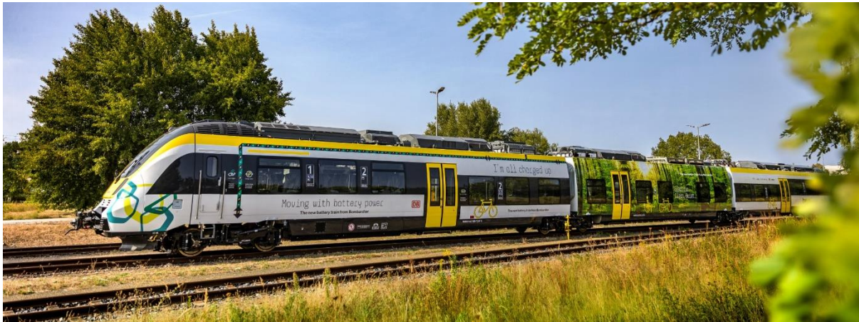
Figuur 14: batterij-hybride Talent 3
