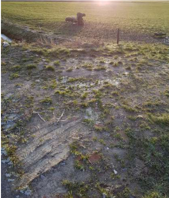
Dam 2: Puinhoudende grond
