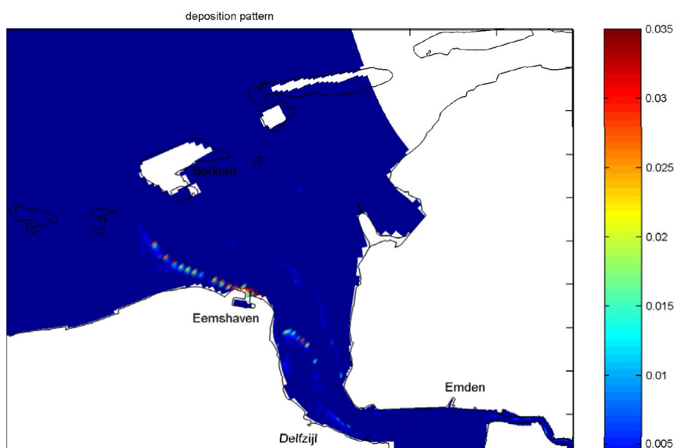
Figuur 2: Berekend depositiepatroon van baggerspecie, verspreid op P5, 9 dagen na het stoppen van de verspreiding (Alkyon A1836R8r1)
