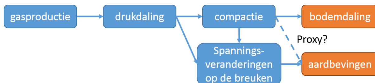
Figuur 3-1: Afhankelijkheden tussen productie, drukdaling, compactie, bodemdaling, spanningen op de breuken en aardbevingen (zie ook bijlage III SodM advies winningsplan Groningen 2016 en SodM advies april 2017).
