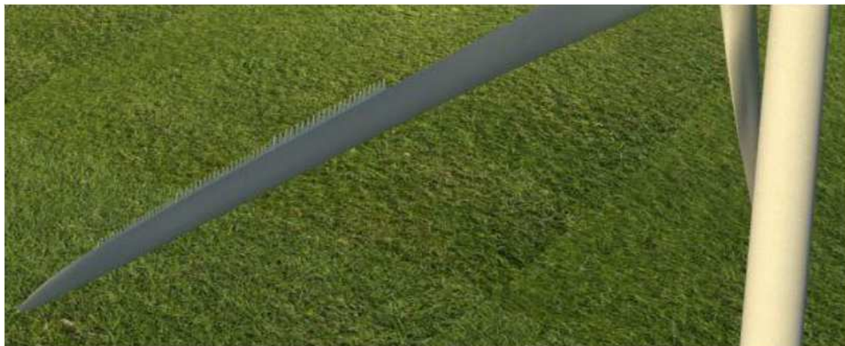
FIGUUR 4.2 WINDTURBINE ROTORBLAD UITGERUST MET 'SERRATED TRAILING EDGE'
