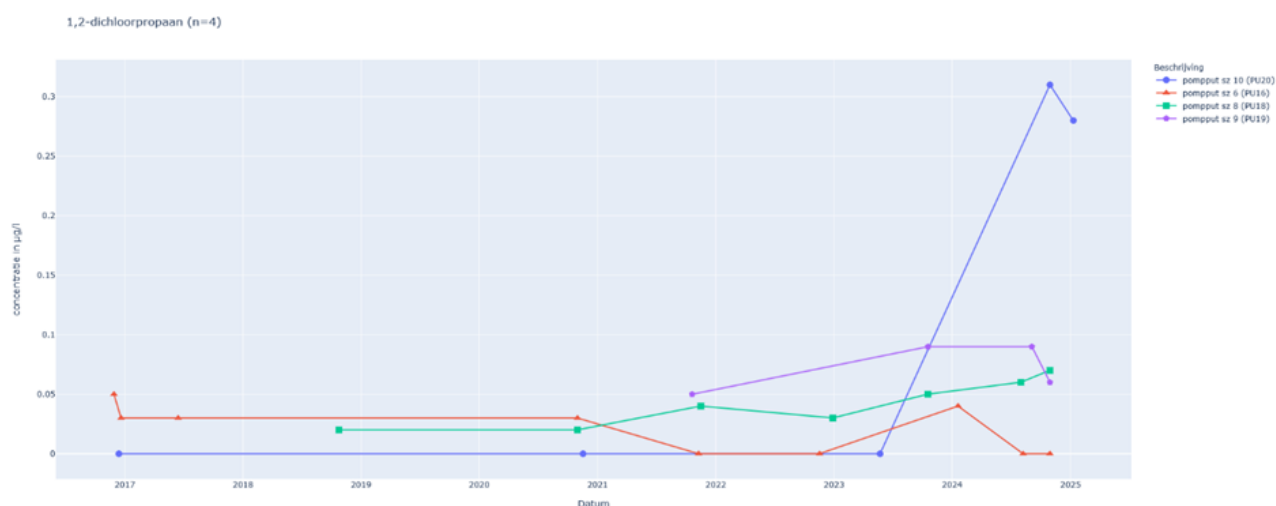
Figuur 5-2: Trendanalyse 1,2-dichloorpropan in de pompputten van Sellingen tussen 2017 en 2025.
