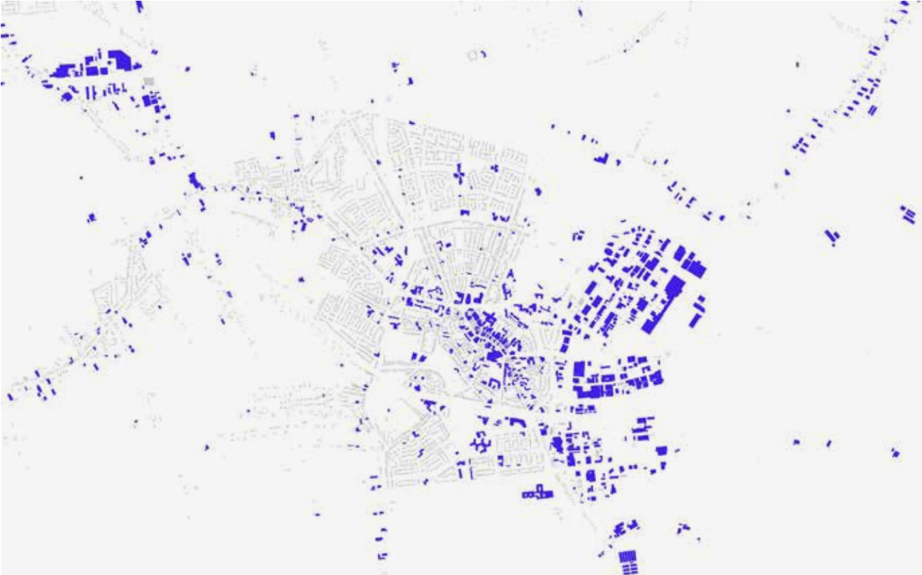
2.10 Een overzicht van de grote daken in Winschoten (groot genoeg om mee te tellen voor de RES); vooral de bedrijfsdaken aan de oostzijde van de stad (Reiderland, Rensel, Hoogebrug) vallen op. Niet alle daken zijn constructief geschikt voor zon, maar de potentie is het onderzoeken waard.
