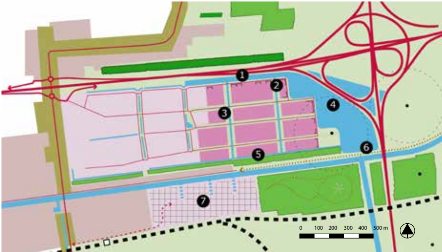
4.18 Mogelijke uitwerking voor de Gouden Driehoek met 1) weg buitenom, 2) voorkanten naar A7/N33, 3) parkachtig casco met overwegend Noord-Zuid hoofdstructuur, 4) waterrijke overgang naar knoop A7/N33, 5) groene buffer langs achterkanten naar Winschoterdiep, 6) recreatieve verbinding langs het Winschoterdiep en 7) kans voor herstructurering van Industrieweg-West naar een per spoor goed ontsloten waterrijk suburbaan woonmilieu met parkachtige uitloop aan de oostzijde
