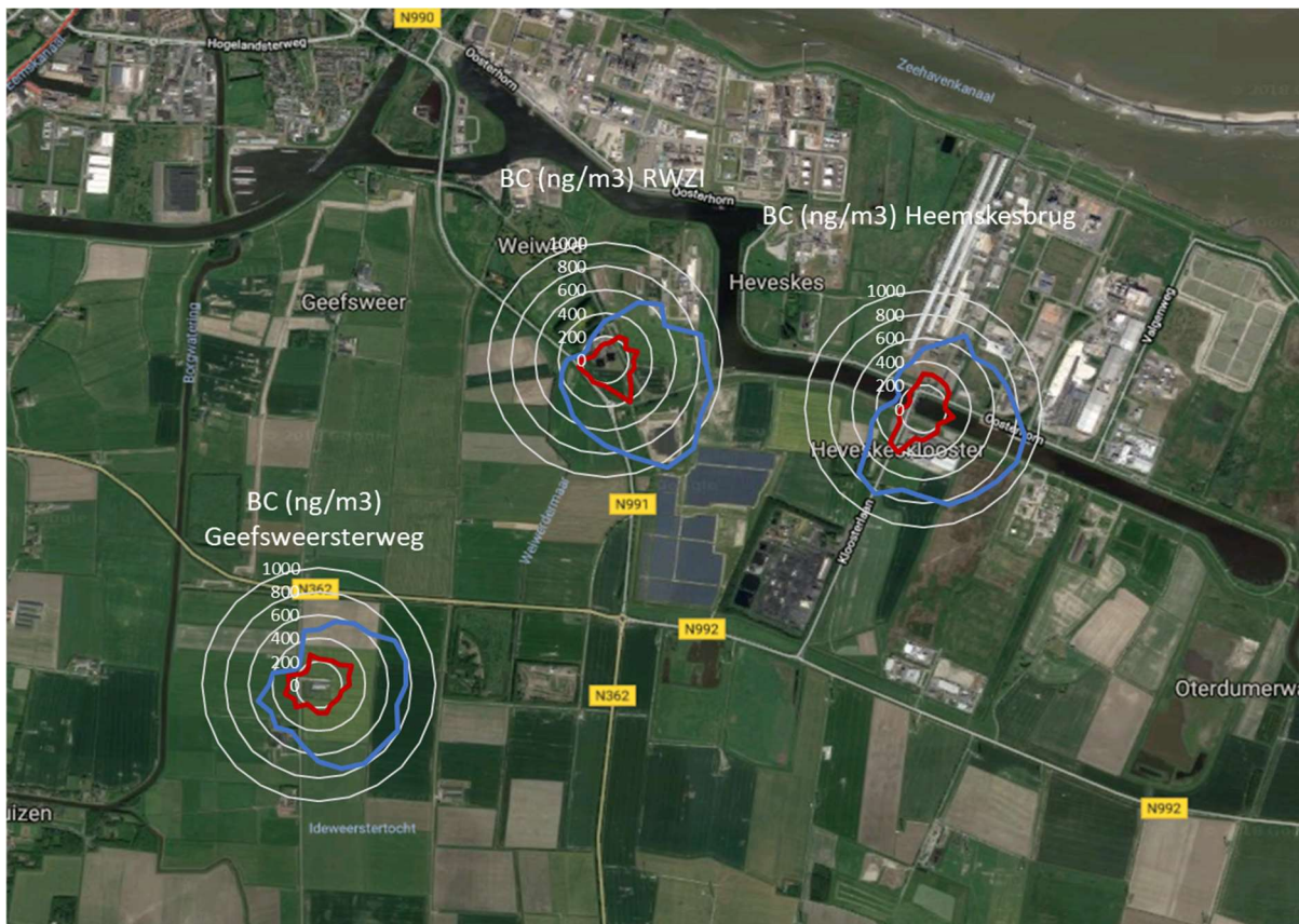
Figuur 21 Windrozen van de concentratie black carbon (BC) op de drie hoofdmeetstations in en rondom het industriegebied Oosterhorn, gemeten met MAAP monitoren in de periode 1 oktober 2018 tot en met 31 december 2019. De blauwe lijn is de absolute concentratie BC en de rode lijn is de concentratie BC vanuit lokale bijdragen (met aftrek van de achtergrond).
