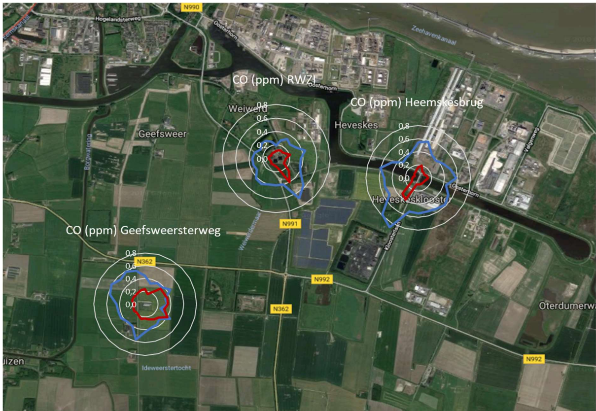
Figuur 24 Windrozen van de concentratie koolmonoxide (CO) op de drie hoofdmeetstations in en rondom het industriegebied Oosterhorn, gemeten met online CO monitoren in de periode 1 oktober 2018 tot en met 31 december 2019. De blauwe lijn is de absolute concentratie CO en de rode lijn is de concentratie CO vanuit lokale bijdragen (met aftrek van de achtergrond).
