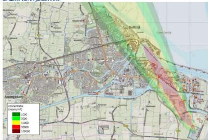
Figuur 5. Berekende ISO-contouren van de uurgemiddelde concentratie van vrije SiC vezels >5µm in de lucht op 1.5 m hoogte tijdens de blazer van 24 januari 2019.
