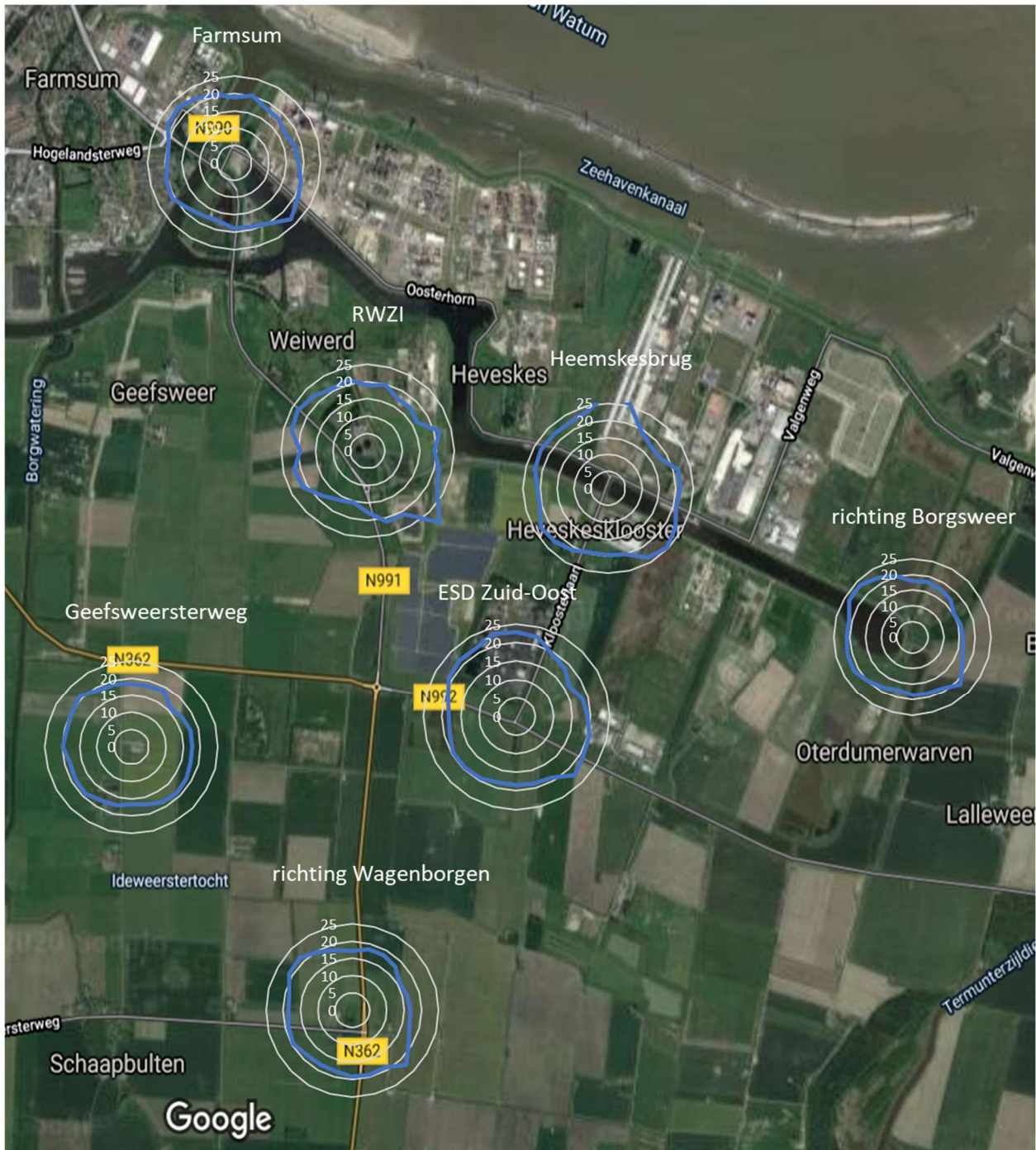
Figuur 14 Windrozen 14 van PM 10 concentraties op zeven meetstations in en rondom het industriegebied Oosterhorn, gemeten met CAIREboxen in de periode 29 november 2018 tot en met 31 december 2019.
