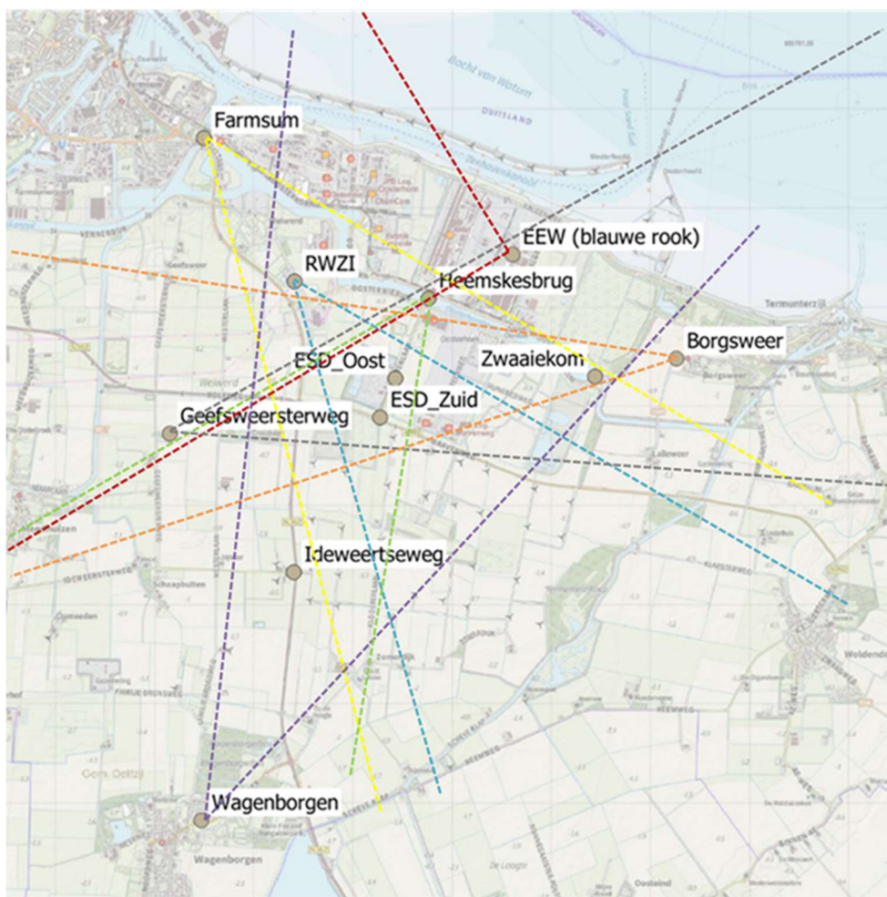
Figuur 3 De ligging van de meetlocaties in het meetnet Oosterhorn en de windhoek waarin ze lucht bemonsteren. De hoofdstations zijn Geefswesterweg, Heemskesbrug, en RWZI Delfzijl, deze zijn voorzien van alle monitoren (CO, BC en fijn stof). Op de locaties Ideweertseweg, Zwaaiekom, ESD_Oost en ESD_Zuid wordt alleen fijn stof gemeten met CAIREboxen.
