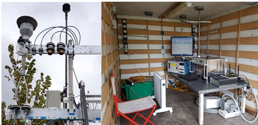
Figuur 2 Monsternemingsapparatuur op het meetstation Geefswesterweg uit het meetnet Oosterhorn. Op de linker foto is de PM10 lucht inlaat (linksboven) te zien met enkele filterhouders daaraan gekoppeld. Daarnaast twee SEM/EDX filterkopjes en twee TSP filterkoppen met helemaal boven de luchtinlaat voor de BC en CO monitoren. Op de rechter foto zijn de BC- en CO-monitor te zien.
