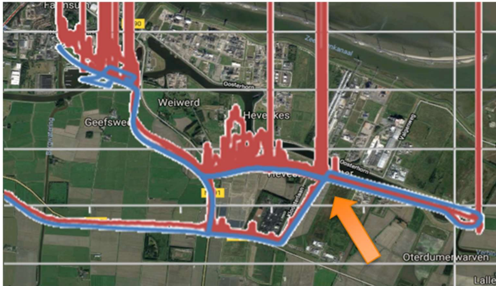
Figuur 4 Gemeten concentratie van CO (rode lijn) tijdens de mobiele metingen met de meetwagen. De oranje pijl geeft de tijdens de metingen heersende windrichting aan. De blauwe lijn geeft de afgelegde weg. Pieken aan de zuidoostkant van ESD-SiC zijn waarschijnlijk veroorzaakt door uitlaatgassen van passerende voertuigen of van de eigen mobiele meetwagen.
