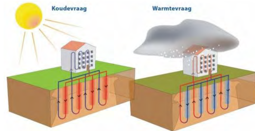
Figuur 3.1a: gesloten warmte- en koudeopslagsystemen oftewel bodemwarmtewisselaars.
