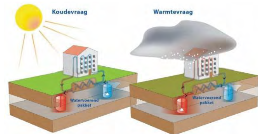
Figuur 3.1b: Open warmte- en koude opslagsystemen.
