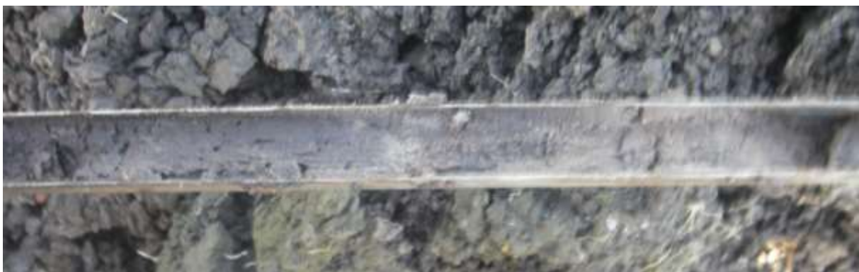
Figuur 13: Foto van boring 24 met de verspoelde top van het dekzand.
